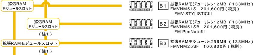
注1) FM PenNote モデルT1では拡張メモリスロットに標準メモリが搭載されています。
