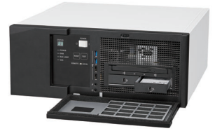
*写真はN5510/FAのオペレーションパネルカバーを開いた状態。
