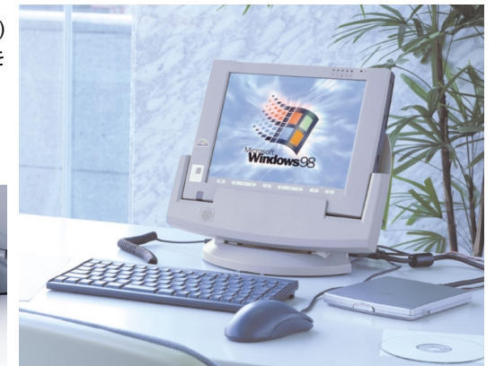
【ポータリプリケータにFM PenNote本体を接続した状態】 ポータリプリケータ、キーボード、マウス、CD-ROMドライブはオプション
