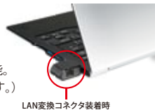
LAN変換コネクタ装着時
