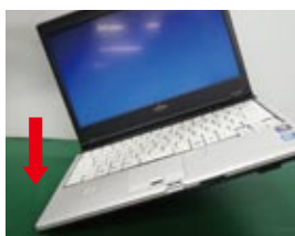
装置動作中に誤って転倒させた場合を想定し、HDD等への影響を確認します。
