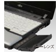
モバイルプロジェクターユニット 装着時(P772/E用)
