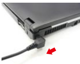
コネクタ部の耐久性を確認するため、ACアダプター、USB、PCカードなどの各種インターフェースに対し、コネクタ挿抜の繰り返しや、大きな力で引っ張るといった試験を行い、強度のチェックを行います。
