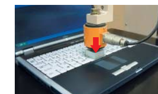
一定の荷重を繰返し加えることにより、装置実装状態での各種部品への影響を確認します。
