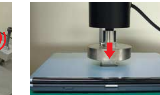
液晶パネルの外側の一点に荷重を加え、液晶パネルの強度チェックを行います。
