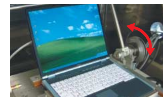
液晶パネルの開閉動作を繰り返し、破損などがなければ耐久性のチェックを行います。
