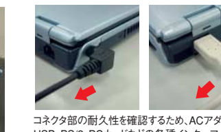
コネクタ部の耐久性を確認するため、ACアダプター、USB、PS/2、PCカードなどの各種インターフェースに対し、コネクタ挿抜の繰り返しや、大きな力で引っ張るといった試験を行い、強度のチェックを行います。
