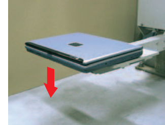
ノートPC本体を落下させ、本体強度のチェックを行います。
