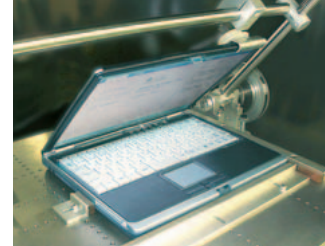
液晶パネルの開閉動作を繰り返し、破損などがなく耐久性のチェックを行います。
