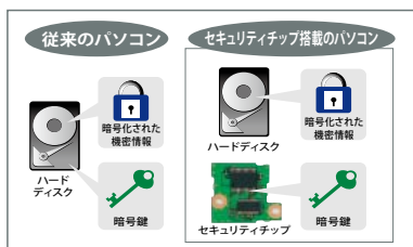
仮にHDDをはずして別のパソコンにつなげたとしても、暗号鍵などの重要データは持ち出せないため機密が保たれます。
